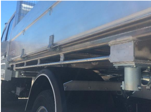
Barre d'attache sous les bordures latérales de la benne (attention, arrimage déjà possible dans la bordures)
